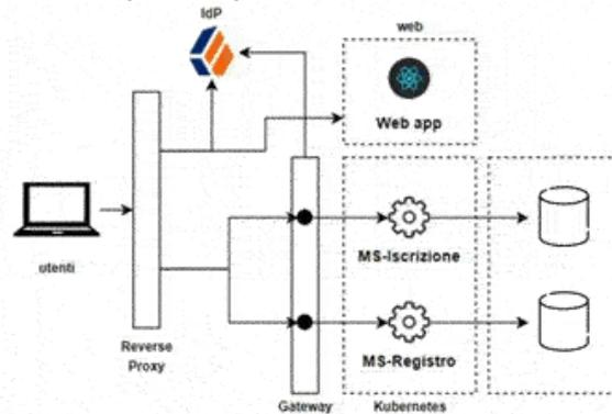
Figura 2 - Architettura applicativa del sistema RUI
